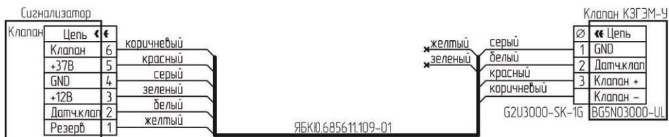
а) схема подключения КЗГЭМ-У;
